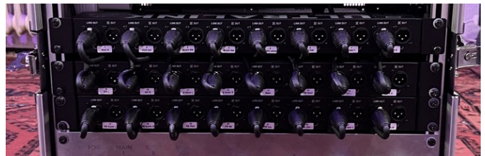
Analoger Splitter an der Rückseite des IEM-Racks
